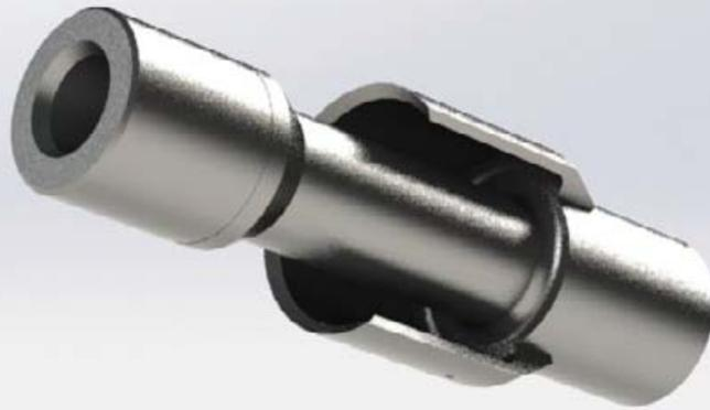
打捞杯主要用来捞取钻井过程中泥浆循环无法带出井眼的较重钻屑或金属碎屑。对保持井底干净，提高钻头使用寿命，减少和防止钻头意外损坏有重要作用。
