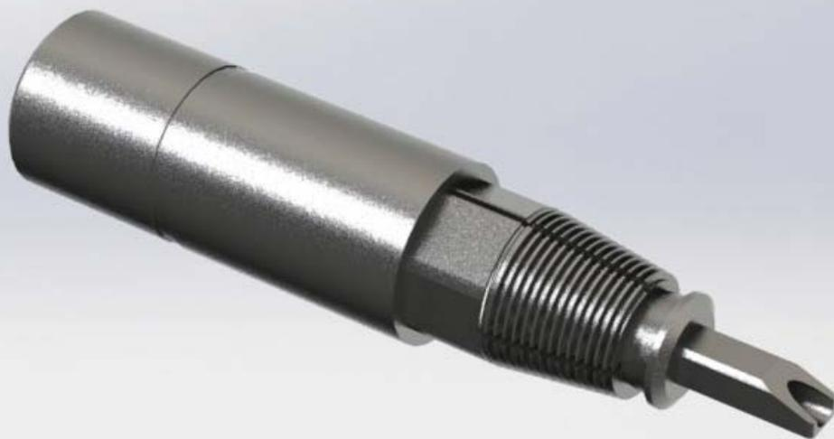
倒扣接头也叫倒扣捞矛，是用来在钻、修井过程中倒出卡点以上被卡钻柱的专用工具。打捞或倒扣时，若落鱼被卡或倒不开时，可从倒扣接头处退出，取出打捞钻具。
